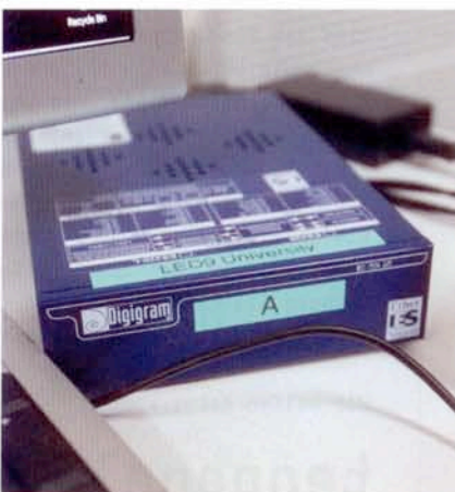
EtherSound-Datenpakete wurden über Konverter (Digigram ES220) in analoge Audiosignale gewandelt.
