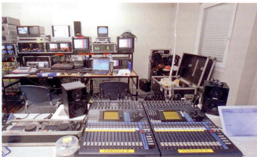
In der Event-Regie lagen sämtliche Zuspielungen (ORF, Satelliten-Downlink, Werbejingles etc.) doppelt auf zwei Yamaha-Pulten des Typs 01V96 auf.
